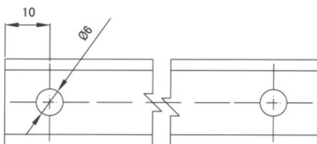
Пробивка отверстия под ручку в профиле створки
